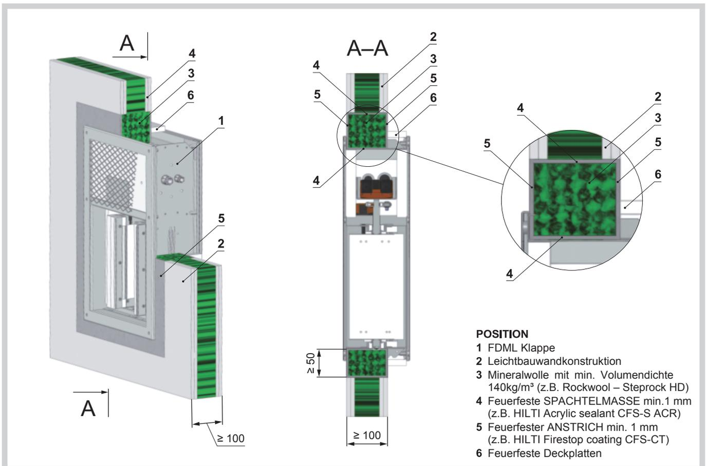
**Einbaubeispiel mit Luftkanalanschluss von beiden Seiten**
