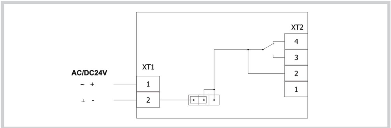
**Block-Anschlussschema Ausführung .41 - mit Stellantrieb BLF 24-T (BF 24-T), Rauchmelder und Netzgerät**
