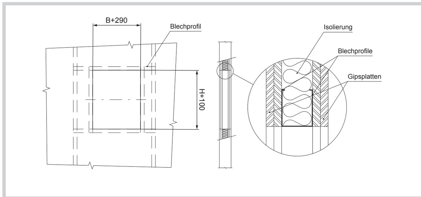
**Einbau Beispiele der Brandschutzklappen in massive Wandkonstruktionen**
