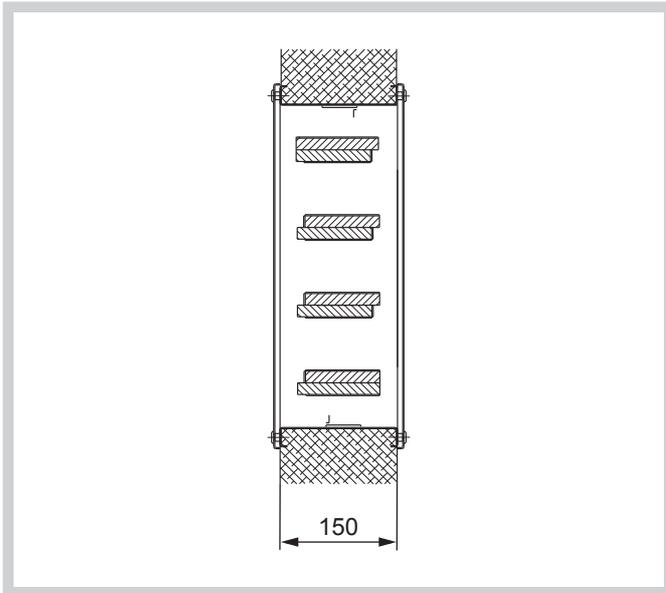
Massive Wandkonstruktion mit Wandstärke > 150 mm
