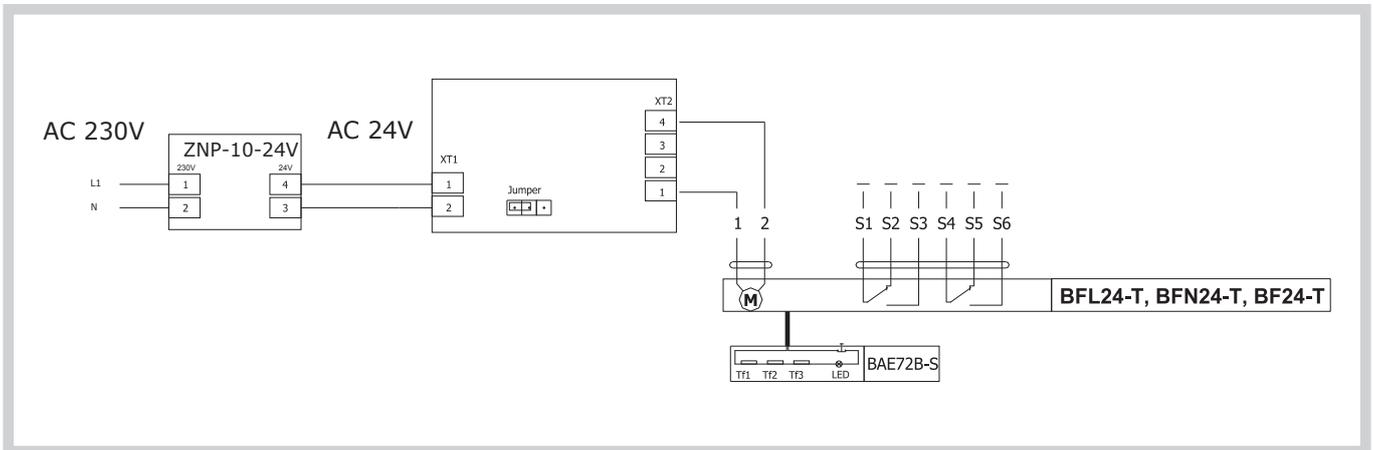
**Block-Anschlussschema Ausführung .51 - mit Stellantrieb BLF 24-T (BF 24-T) und Rauchmelder**
