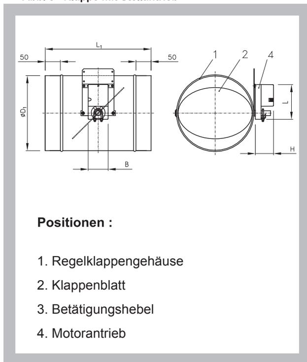
Zur Bestückung des Servomotors sind Klappen mit einem vierkantigen Bolzen und einem Maß von 10 mm vorgesehen.
