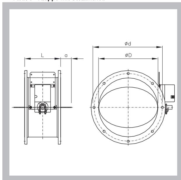
Klappe zum Anschluss an Wickelfalzrohre
