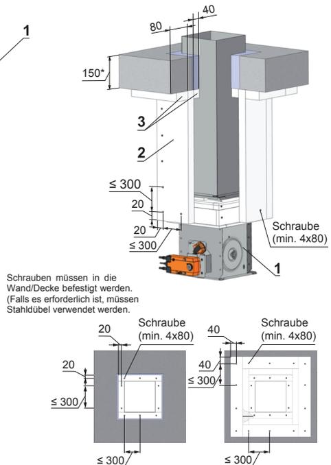
Schrauben müssen in die Wand/Decke befestigt werden. (Falls es erforderlich ist, müssen Stahldübel verwendet werden.)
